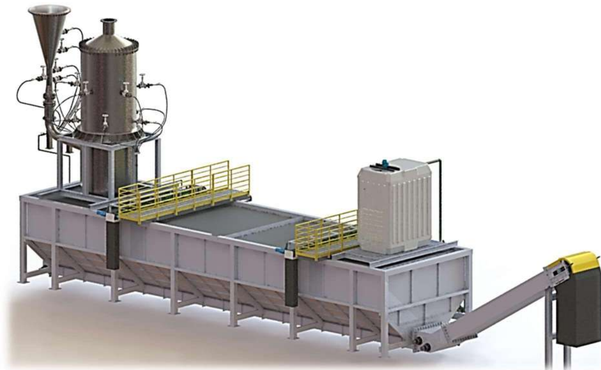
Figura 114. Sistema de lavagem dos gases
