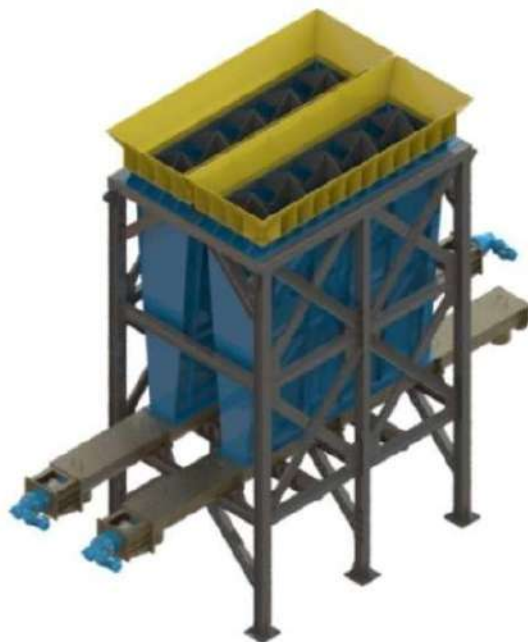
Figura 123. Sistema de alimentação de carbonato de cálcio, ao lado de silo de autonomia de areia
